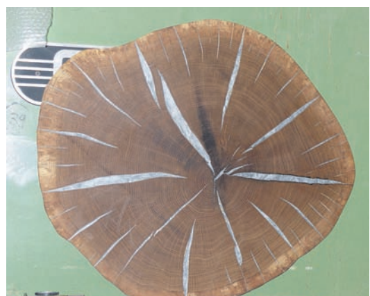
So sahen Hirnholzquerschnitte früher nach der Trocknung aus (l.) und so – ohne Risse – mit Rainer Böhmes neuer Trocknungstechnik.
